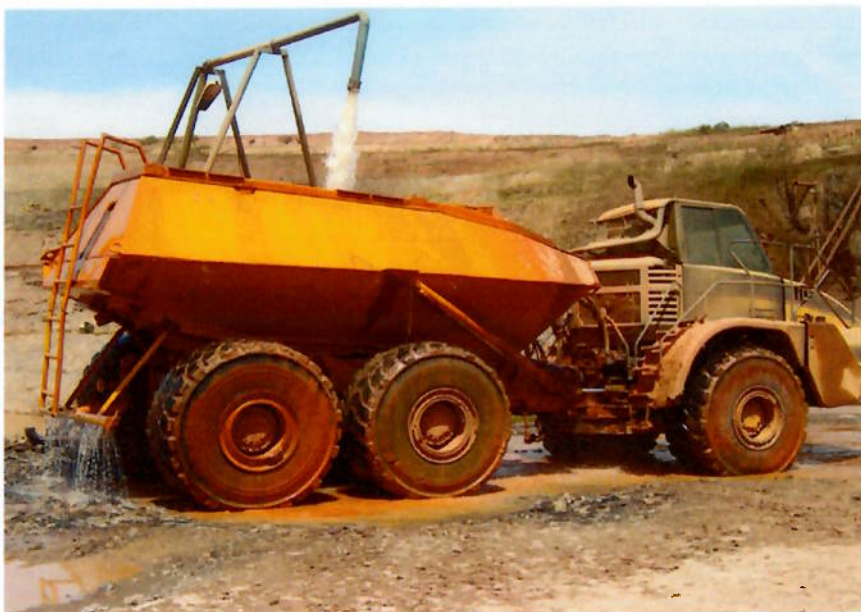
Figura 39 - Caminhão pipa a ser abastecido com água
