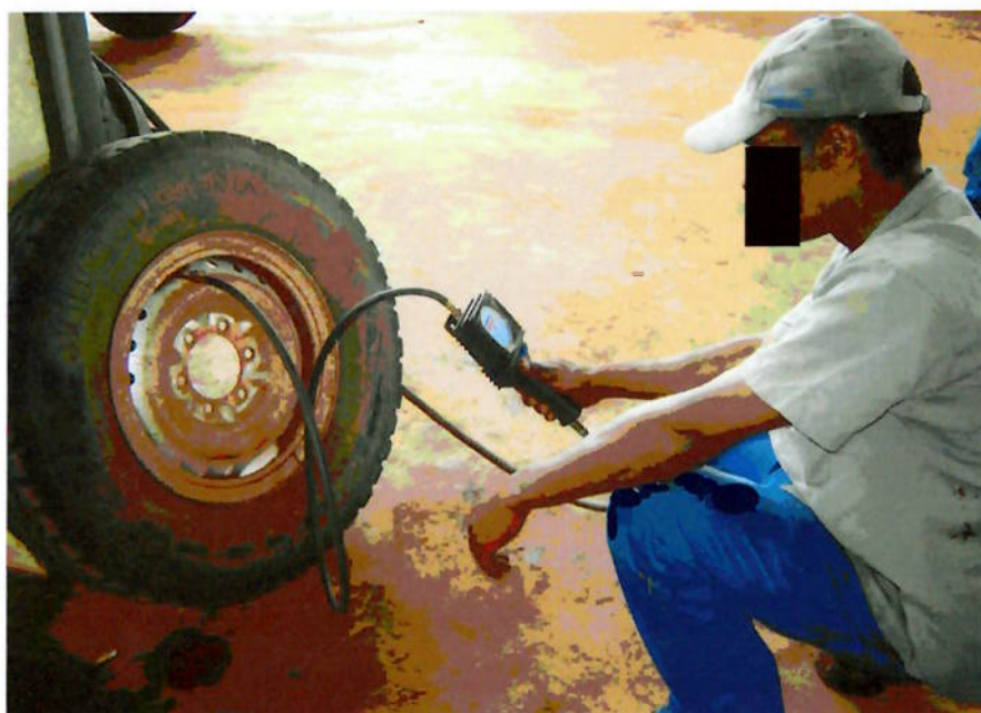
Figura 35 - Detalhes de calibração de um pneu
