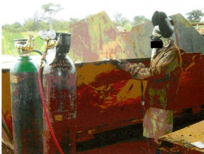
Figura 30 - Processo de Soldagem Oxiacetilênica
