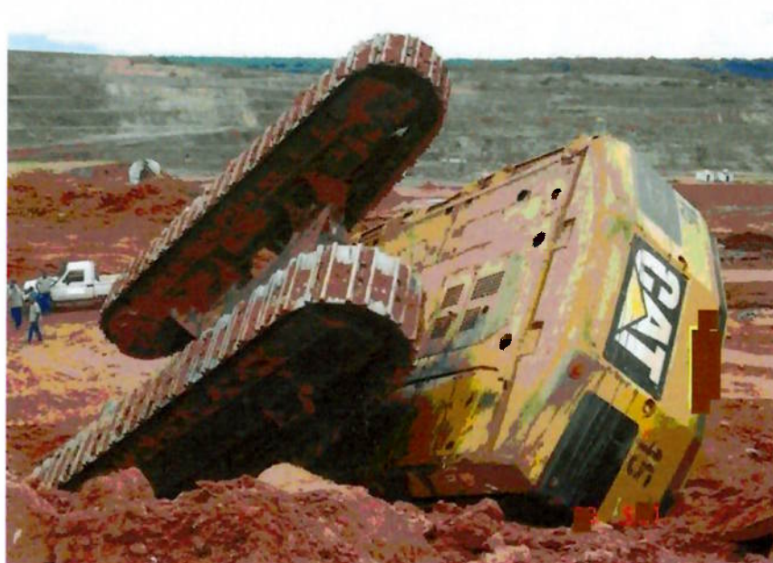
Figura 3 -Tombamento de uma escavadeira numa bancada para outra de nível inferior
