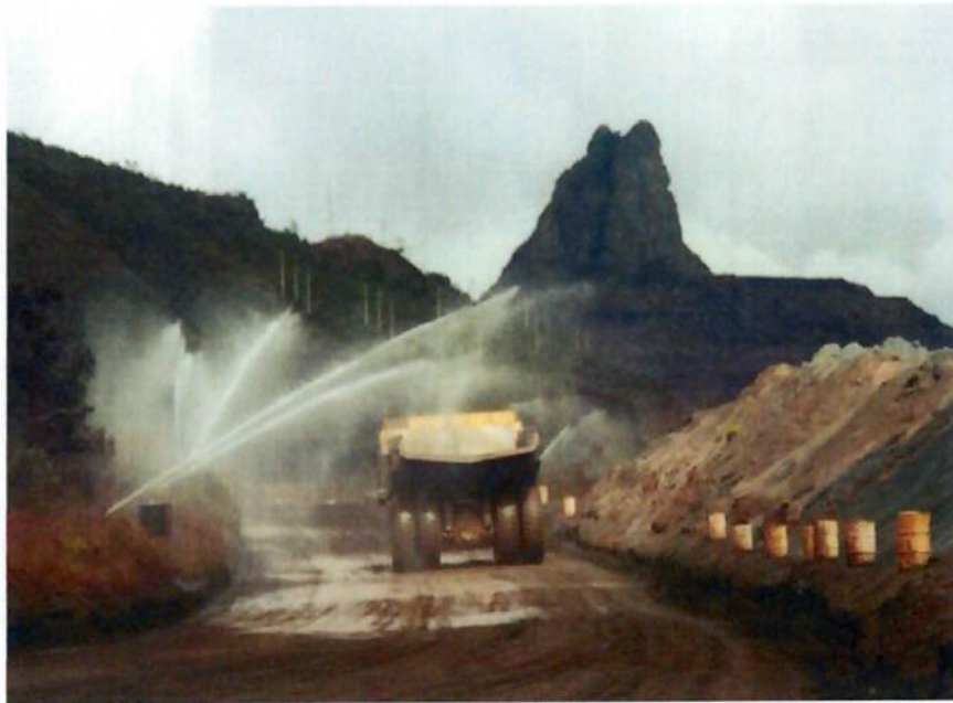
Figura 41 - Controle do sistema automatizado de combate a poeiras
