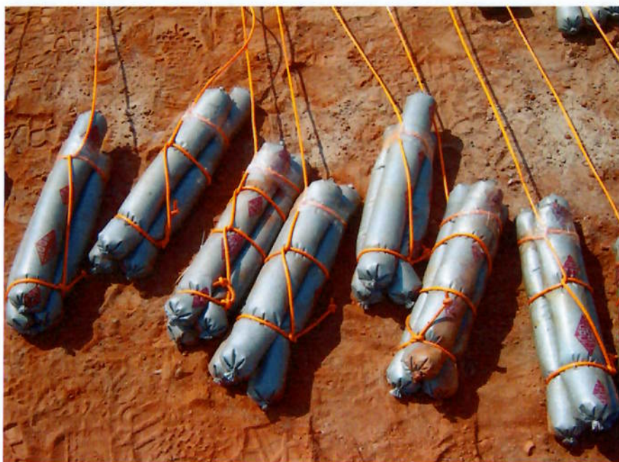
Figura - 7 Substância Explosiva amarrada ao cordel detonante
