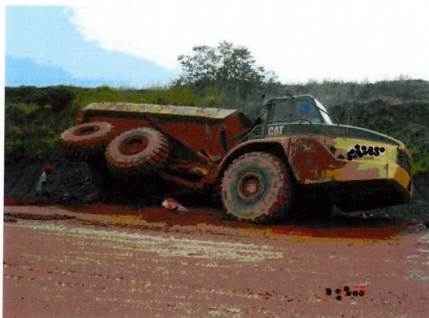
Figura 14 - Tombamento do caminhão na vala
