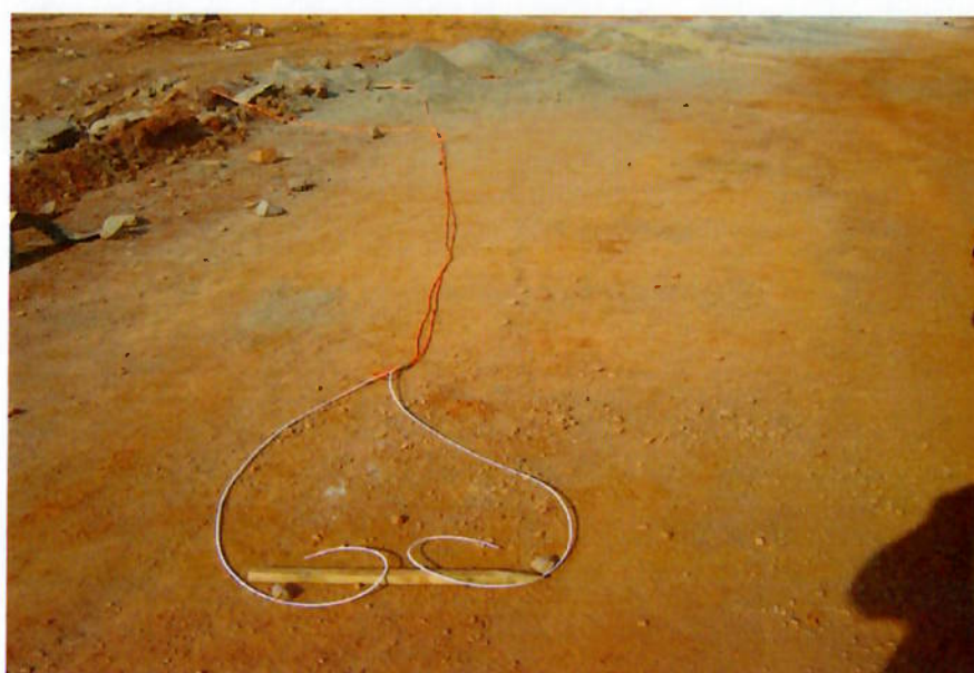
Figura 9 – Stopim ligado ao cordel detonante
